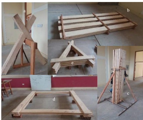
Figura 1 Formas de secado de la especie B. lactescens por el método de apilado: a) caballete, b) horizontal, c) vertical, d) Cuadrado, e) Triangulo Fuente: Elaboración propia.
